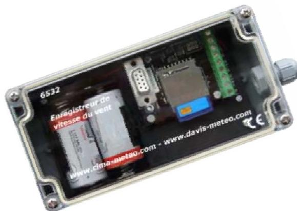
Notre solution répond aux besoins d'enregistrements de la vitesse et direction du vent pour des périodes longues et sur des sites ne disposant d'aucune alimentation électrique.
