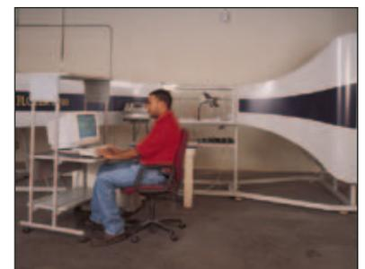
Les anémomètres sont testés dans la soufflerie de notre usine de Californie.
