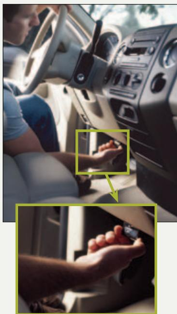
Les bouchons CarChip pro s'installent discrètement et instantanément dans le port OBDII de votre voiture ou camion.
